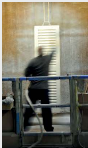
3 COUCHES DE FINITION après un égrenage manuel
